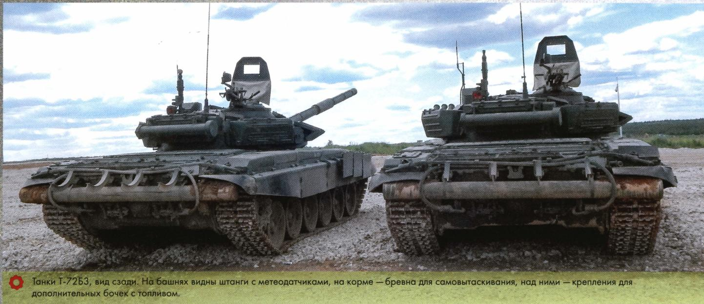
Танки Т-72Б3, вид сзади. На башнях видны штанги с метеодатчиками, на корме — бревна для самовытаскивания, над ними — крепления для дополнительных бочек с топливом.
