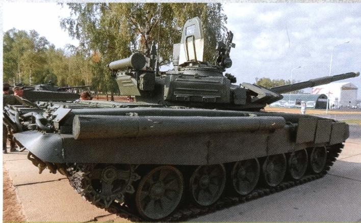
Танк Т-72Б3М, вид справа. В отличие от Т-72Б3, на этой машине бревно для самовытаскивания закреплено не на корме, а на правом борту.
