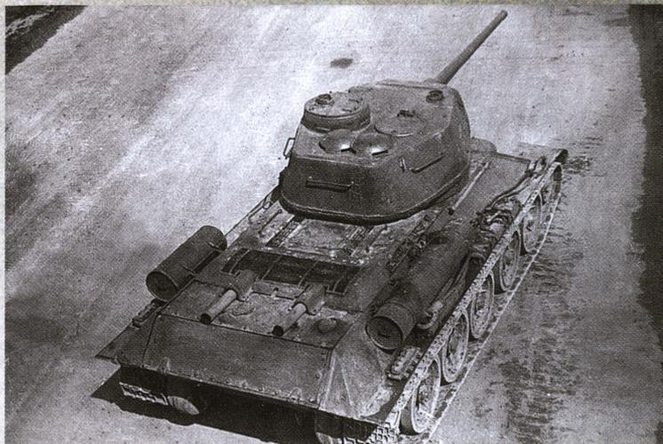
Танк Т-34-85М, второй вариант, вид сверху. На фото хорошо видна измененная бронировка кормы машины.
