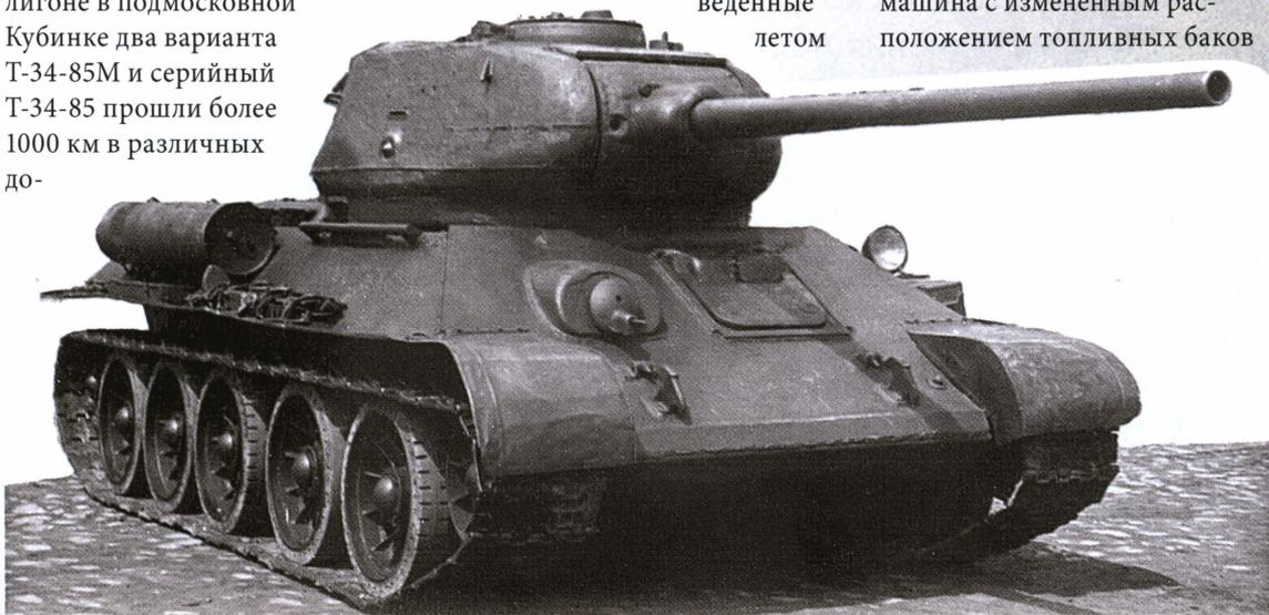
Первый вариант Т-34-85М, общий вид. Внешне танк отличается от серийного Т-34-85 утолщенным лобовым листом корпуса. Хорошо видно, что в нижней части лист выступает над нижним листом корпуса.
