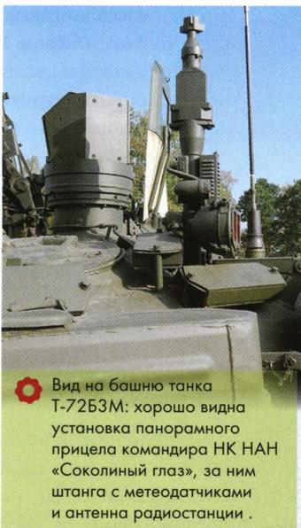
Вид на башню танка Т-72Б3М: хорошо видна установка панорамного прицела командира ПК НАН «Соколиный глаз», за ним штанга с метеодатчиками и антенна радиостанции.
