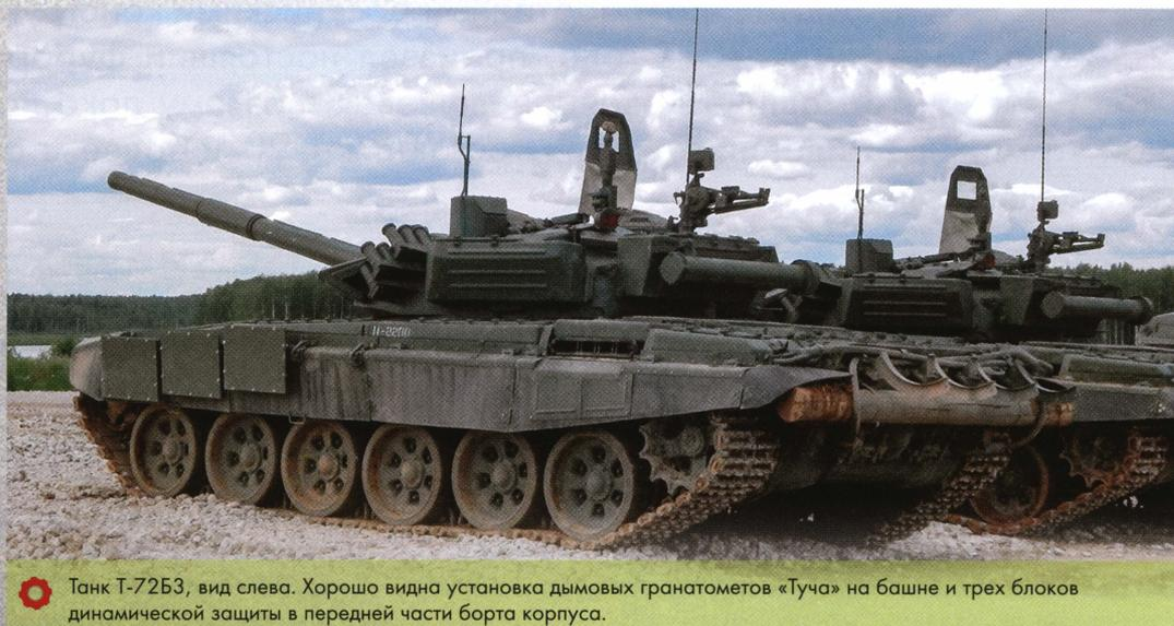
Танк Т-72Б3, вид слева. Хорошо видна установка дымовых гранатометов «Туча» на башне и трех блоков динамической защиты в передней части борта корпуса.
