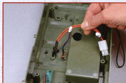
**2** Вставьте выключатель питания в слот, расположенный на внутренней стороне нижней части корпуса танка рядом с местом, где установлен переключатель управления Wi-Fi, как показано на снимке.
