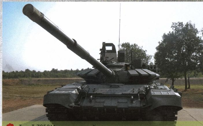
Танк Т-72Б3М, вид спереди. Хорошо видны встроенная динамическая защита «Контакт-5» на корпусе, блоки защиты на бортах и крыше башни, а также установка прицелов «Сосна-У», ТПД-К1 и «Соколиный глаз».
