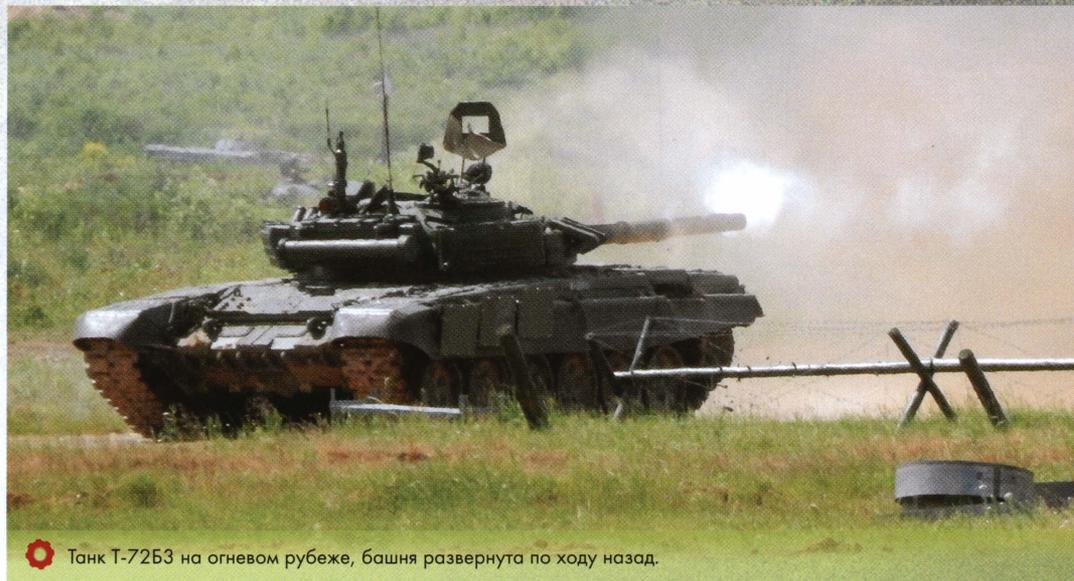
Танк Т-72Б3 на огневом рубеже, башня развернута по ходу назад.
